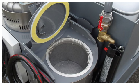
A. Separazione solidi/liquidi Cestello di 15L di pre-filtrazione 2000µm
