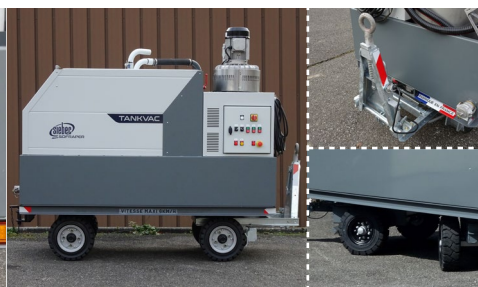
C. Mobilità per esterno Versione con rimorchio completo di ruote in grande diametro. Doppie nella versione da 4000L.
